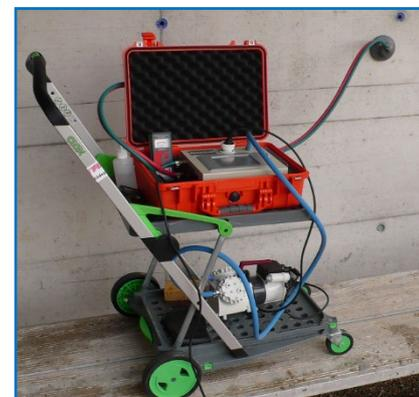
Le test montre que le béton avec AETERNUM est PK1 (c'est-à-dire avec une pénétration très faible et donc une porosité très faible) par rapport au béton sans AETERNUM qui a une pénétration modérée/élevée et donc une porosité.
