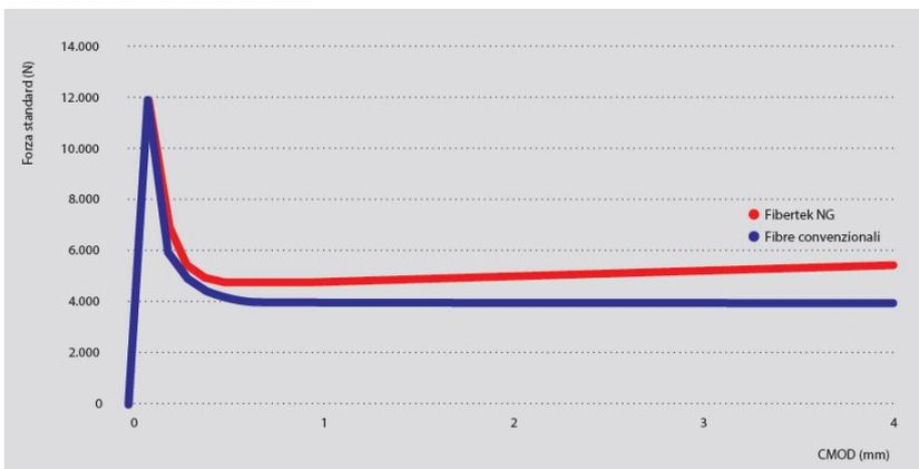
Ottima dispersione ed elevata superficie di contatto per un'estrema aderenza alla pasta cementizia. Contrasta il ritiro plastico, incrementa la resistenza a trazione residua del calcestruzzo. Un fattore caratteristico è che anche notevoli quantità nell'impasto non scaturiscono appallottamenti o nidi e quindi non necessitano di attrezzature particolari per la loro distribuzione e carico.
